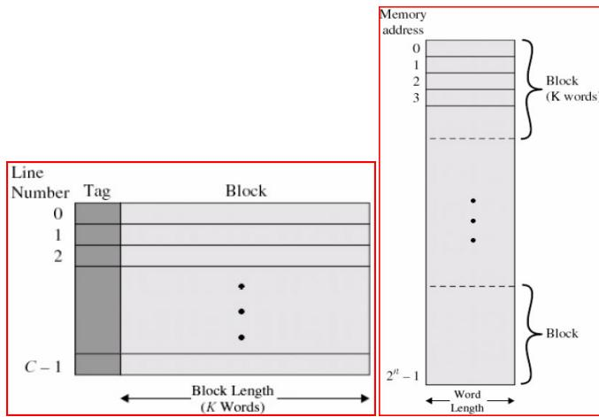
Sur cet exemple, chaque mot mémoire a une adresse unique de  $n$  bits. Pour faciliter les transferts vers le cache, la mémoire principale est organisée en blocs de **K mots**, il y a au total **M blocs**. Le cache a quant à lui **C lignes** de **K mots** chacune. « **Tag** » indique le bloc courant stocké dans une ligne (ce « **Tag** » est nécessaire car **C** est très petit par rapport à **M**).
