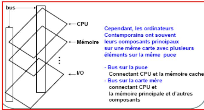
Si plusieurs composants sont interconnectés par un seul bus, la performance du système peut être fortement affectée, car plus il y a de composants sur un bus, **plus celui-ci doit être long (ce qui entraîne une augmentation des délais de propagation des signaux)** et **plus il y a de chance** que les demandes cumulées des transferts de données approchent la capacité du bus (*le bus devient alors un goulot d'étranglement, on parle alors de bus bouchonné*).
