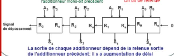
La sortie de chaque additionneur dépend de la retenue sortie de l'additionneur précédent: Il y a augmentation de délai!
