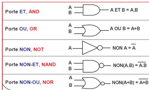
Un jeu de portes est dit fonctionnellement complet s'il permet d'implémenter n'importe quelle fonction booléenne. De telle façon, on simplifie la conception et la fabrication des circuits car on se limite à un ou 2 types de portes. Les circuits numériques sont souvent implémentés uniquement avec des portes NON-ET ou uniquement avec des portes NON-OU.
