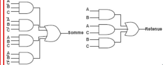
La construction basée sur des additionneurs mono-bits est limitée par l'accumulation des délais de propagation. La solution est de construire des additionneurs de plus de 1 bit, par exemple construire sur des additionneurs de 8 bits.
