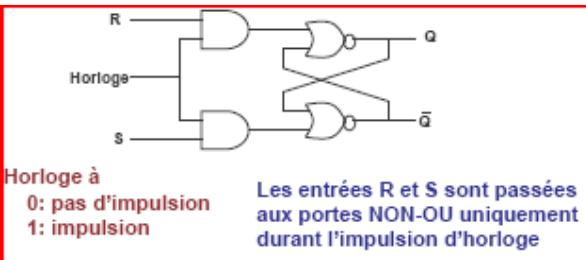
Dans un ordinateur, les événements sont en général synchronisés par une impulsion horloge. Les changements se produisent uniquement au moment de l'impulsion d'horloge. La **bascule R-S avec horloge** permet de mettre en œuvre ce fonctionnement où les changements sont contraints par l'impulsion horloge.
