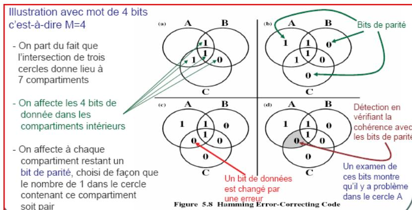
Pour mettre en évidence les concepts sous-jacents au code de **Hamming**, développons un code de **Hamming** capable de détecter et corriger un seul bit erroné sur des mots de 8 bits (c à d M=8).
